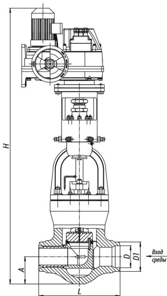
**Присоединение к трубопроводу:** с помощью сварки.
